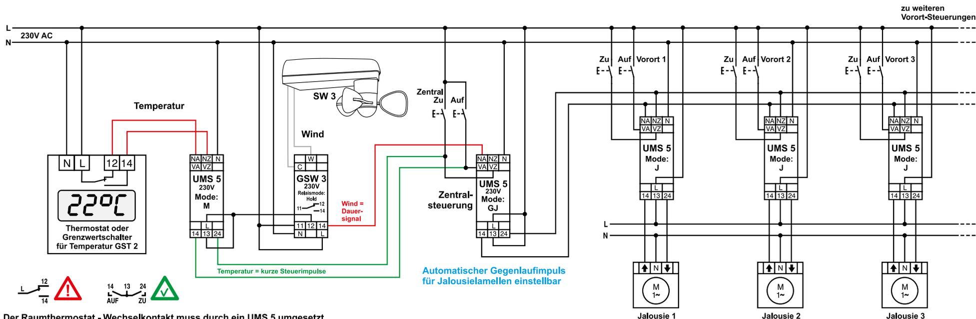
Der Raumthermostat - Wechselkontakt muss durch ein UMS 5 umgesetzt werden in zwei getrennte Schließkontakte mit Laufzeitbegrenzung
