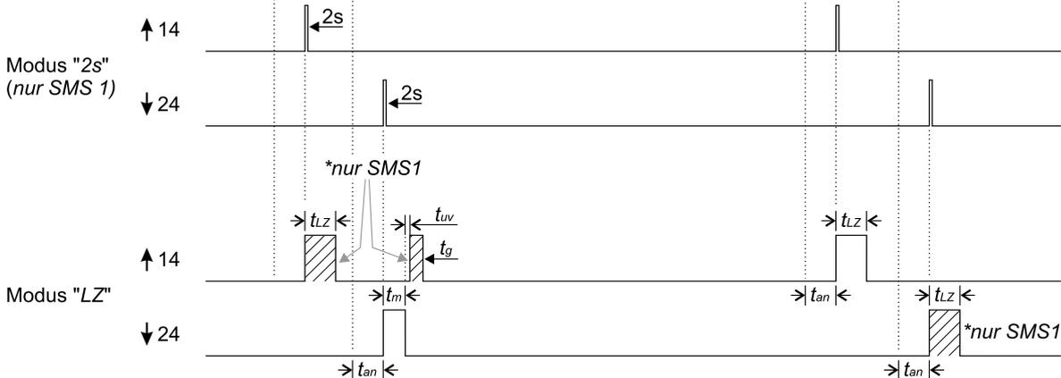
Wenn die Windgeschwindigkeit (Frequenz der Windsensorimpulse W) den eingestellten Schwellenwert überschreitet, so werden die Vororteingänge „AUF“ (A) bzw. „ZU“ (Z) komplett gesperrt. Auch der Lichtsensor (S) hat währenddessen keine Auswirkung auf die Steuerung. Erst wenn die Windstärke den eingestellten Schwellenwert unterschritten hat, werden die Eingänge wieder aktiv.
